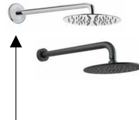
30CR8630 Soffione tondo mm Ø200 ultra sottile in acciaio con braccio doccia 350 mm. Ultra-thin shower head in stainless steel mm Ø200 with shower arm 350 mm. ΚΩΔΩΝΑΣ ΙΝΟΧ ΣΤΡΟΓΓΥΛΟΣ 200mm , 9lt-min έως 14lt/min με Ορειχαλκίνο βραχίονα 350mm
